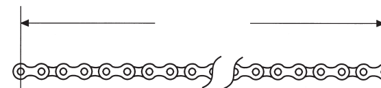
MISURA DI UN TRATTO DI 17 PERNI (16 PASSI)
