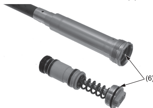
(6) filettatura del tappo della forcella e dello smorzatore della forcella
