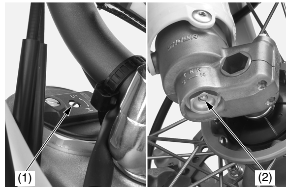
(1) tornillo del ajustador de la amortiguación de compresión (2) tornillo del ajustador de la amortiguación de expansión
