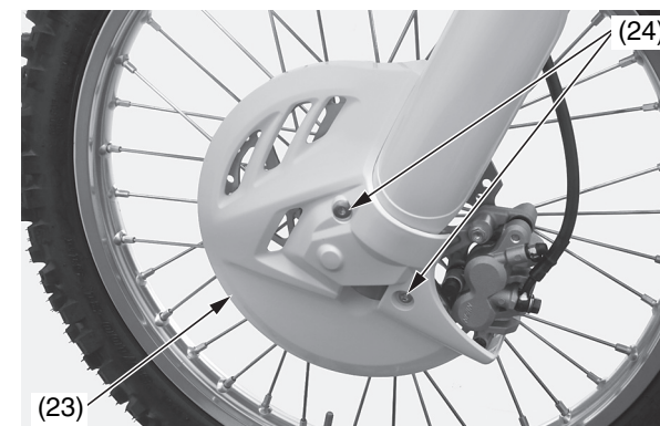
(23) coperchio del disco (24) bulloni a brugola del coperchio del disco
