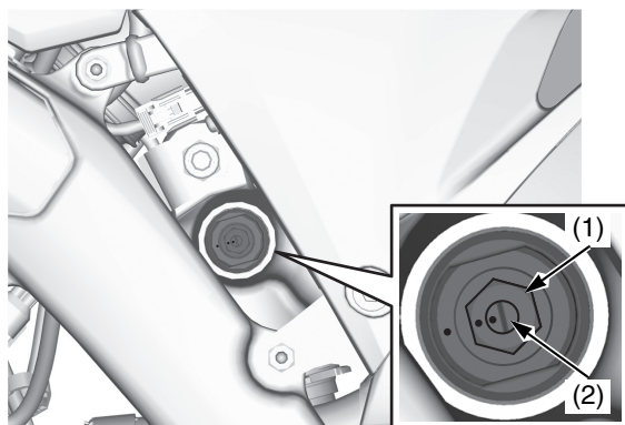
(1) registro dello smorzamento della compressione ad alta velocità (2) registro dello smorzamento della compressione a bassa velocità
