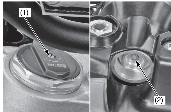
(1) registro dello smorzamento della compressione (2) registro dello smorzamento dell'estensione
