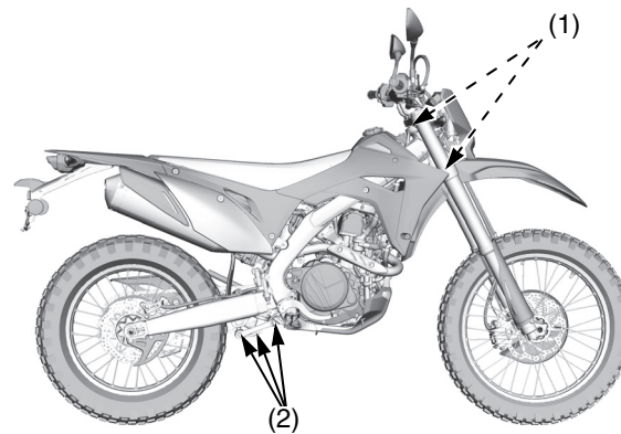
(1) cuscinetti della testa dello sterzo (2) perni di snodo delle sospensioni
